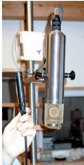
Abb. 8: Size does matter? Monsterprototyp mit zweistufiger Röhrenschialtung
