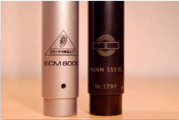
Abb. 6: Das sehr preisgünstige Behringer ECM-8000 und der „Urvater“ der Elektret-Messmikrofone, das Haun MBNM-550el. Schaut man sich...
