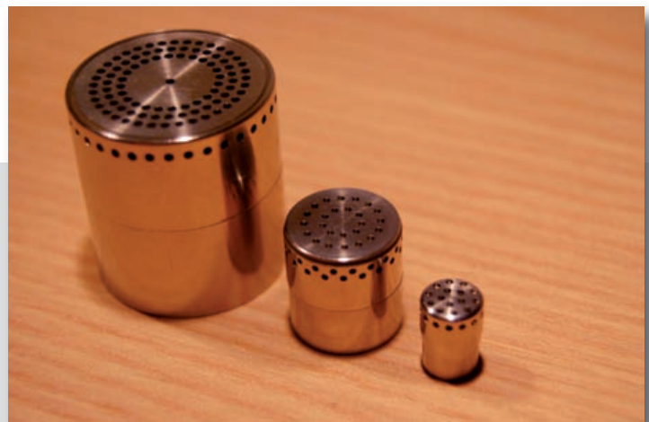
Abb. 9: Drei Kondensator-Messmikrofonkapseln des thüringischen Herstellers Microtech Gefell in den Größen 1 Zoll, 1/2 Zoll und 1/4 Zoll, welche für unterschiedliche Einsatzzwecke ausgelegt sind. Will man beispielsweise das Grundrauschen einer P.A. oder das Lüftergeräusch einer Endstufe messen, bietet sich die Verwendung der sehr empfindlichen 1-Zoll-Kapsel an (hier MK-102, links). Für die Messungen von nichtlinearen Verzerrungen bei hohen Pegeln ist eine 1/4-Zoll-Kapsel meist die beste Wahl – hier hier abgebildete MK-301 (rechts im Bild) verträgt laut Hersteller Schalldruckpegel von bis zu 168 dB. Einen guten Allrounder für die meisten Messungen im Lautsprecherbereich dürfte eine Kapsel mit 1/2-Zoll-Membran (hier die MK-201, mittig) darstellen
