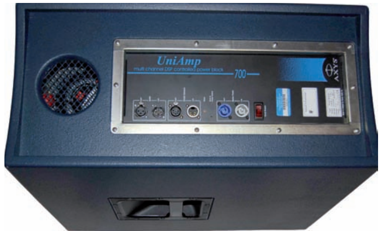
Abb. 5: Die Rückansicht des T-2115 zeigt den „UniAmp“ (Mehrkanalverstärker mit DSP und Netzwerkschnittstellen)
