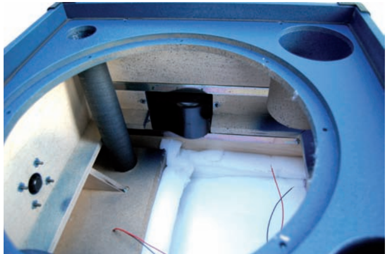
Abb. 7: Blick in den geöffneten Subwoofer B-07 – auch hier erkennt man die schon aus dem Topteil bekannten Schläuche für die Zuführung von Frischluft für die Endstufe
