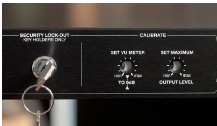
Elegant: Ein Schlüssel verhindert wirkungsvoll unbefugten Zugriff auf die Parameter des SP-2120 von Drawmer – das linke Potentiometer regelt nicht nur das VU-Meter, sondern auch den Threshold
