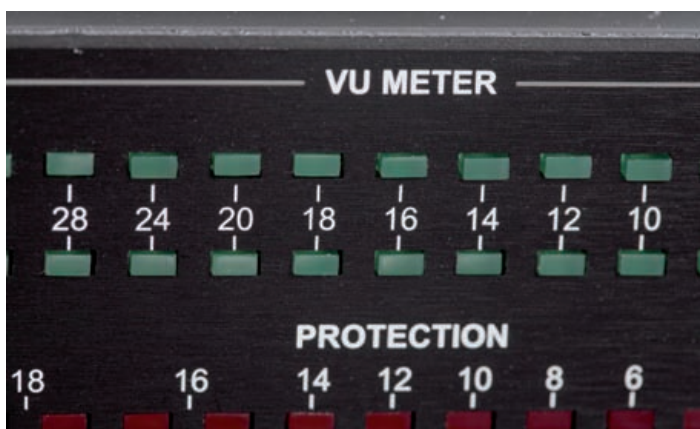
Hochauflösende LED-Ketten geben beim SP-2120 Aufschluss über Gainreduction und Headroom – ungewöhnlich und nicht dokumentiert ist die Tatsache, dass das VU-Meter die Signale des Outputs und nicht die des Inputs zeigt
