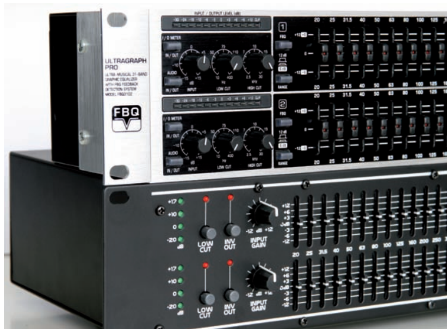
Die Eingangsbereiche unterscheiden sich: Der t.racks lässt die High Cut-Funktion vermissen und bietet lediglich ein festes Low Cut-Filter
