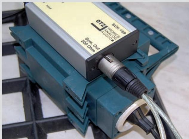
**Bild 2:** Um Brummeinstreuungen zu provozieren, haben wir jede DI-Box auf diesen 50-Hz-Wechselstromtrenntransformator gelegt
