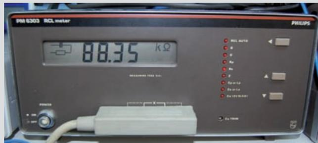
**Bild 4:** Die Messung des Eingangswiderstands ermöglicht diese Philips PM-6303 Messbrücke mit einer Anregungsfrequenz von 1 kHz
