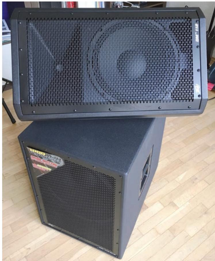
Die DM-112 besteht aus einem Kunststoff-Multifunktionsgehäuse und kann entweder aufrecht (auf einem Stativ) oder auf dem Boden liegend als Wedge genutzt werden
