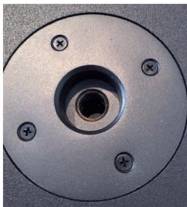
Das M20-Gewinde am Subwoofer sitzt in einer Vertiefung mit 35-mm-Durchmesser – während die mitgelieferte Distanzstange mit 34-mm-Durchmesser exakt durch diese Vertiefung passt, geht dies bei anderen Distanzstangen mit 35-mm-Durchmesser schwer bis gar nicht
