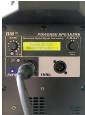
Das Anschlussfeld von DM-112 inklusive beleuchtetem Display für die DSP-Funktionen (EQ, Delay, Polarität, Presets) – der Subwoofer weist zwar kein Display, dafür aber Regler für Pegel, Trennfrequenz und den Bass Enhancer auf
