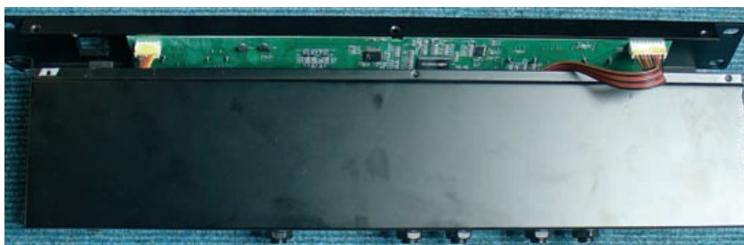
Überschaubares Innenleben – die Hauptplatine befindet sich direkt hinter der Frontplatte
