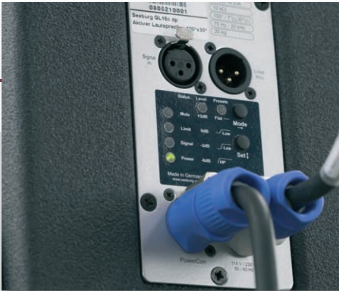
Selbsterklärend: Die Oberfläche des integrierten Controllers mit vier Filteranpassungen
