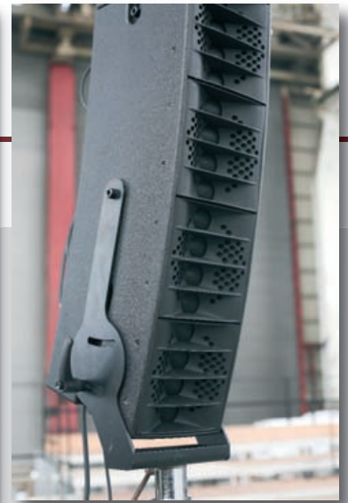
Der Montagebügel eignet sich zum Fliegen und zum Stellen von maximal zwei Modulen, die gestellte Variante schränkt die vertikale Neigung allerdings stark ein
