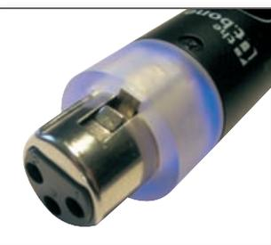
Der Ring aus Plexiglas blockiert die Arretierung der XLR-Buchse des „Micplug“ – hier schaltet man besser ein XLR-Kabel dazwischen
