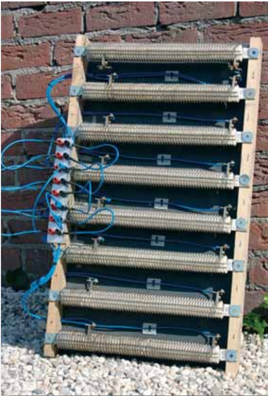
Das ist nicht die Heizung vom Dönergrill nebenan, sondern der 8 x 2.500 Watt Lastwiderstand aus dem tools 4 music Labor
