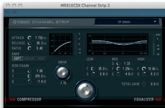
MR-816 CSX Channelstrip mit Kompression und EQ
