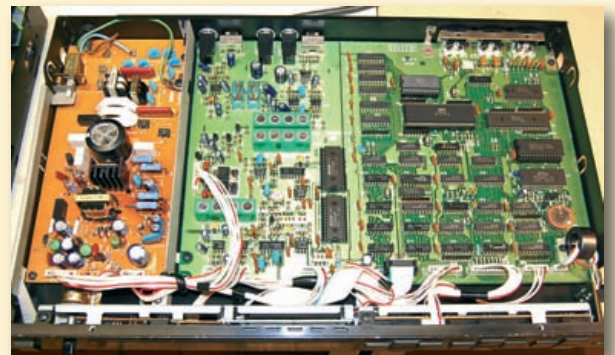
Ein geöffnetes SPX-90 mit Schaltnetzteil
