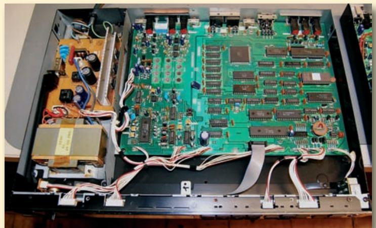
Im SPX-900 ist das Schaltnetzteil einem Linearnetzteil gewichen
