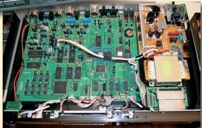
Bild 4a: Das Netzteil im SPX-990 ist nun rechts eingebaut
