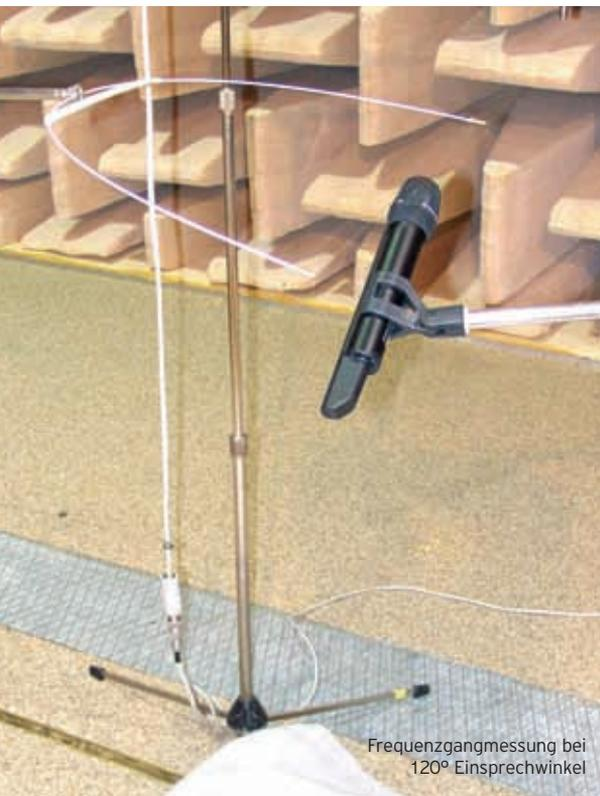
Frequenzgangmessung bei 120° Einsprechwinkel
