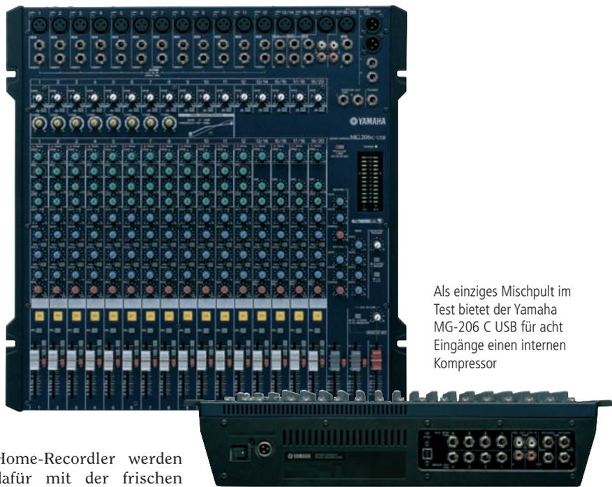
Als einziges Mischpult im Test bietet der Yamaha MG-206 C USB für acht Eingänge einen internen Kompressor
