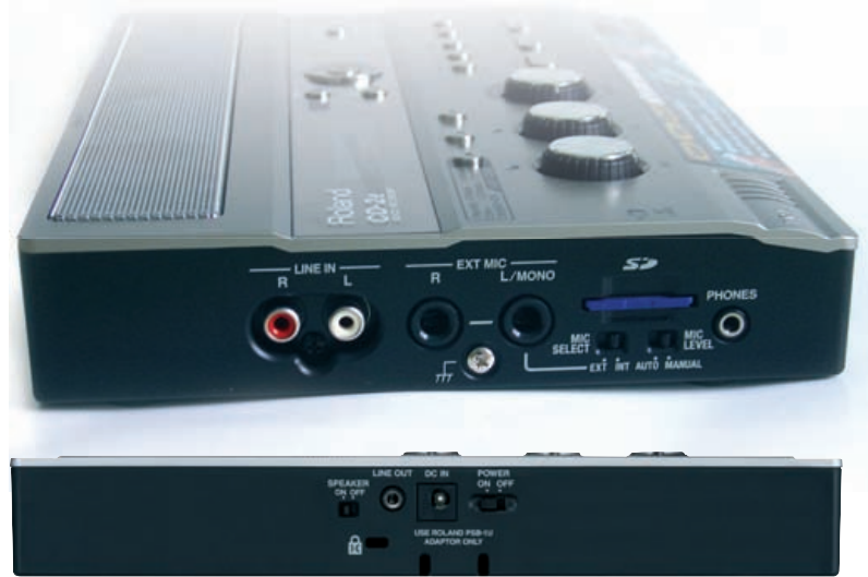
Anschlüsse für externe Mikros liegen nur als 6,3-mm-Klinkenbuchsen ohne Phantomspeisung vor
