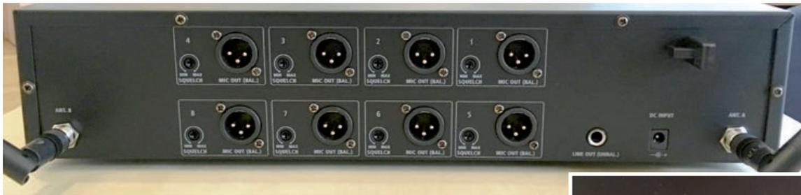
Auf der Rückseite sind sämtliche XLR-Anschlüsse und auch der Regler für die Rauschunterdrückung pro Kanal untergebracht – nach dem Rack-Einbau und bei installierter Verkabelung ist diese Funktion nur schwer erreichbar; Tipp: Der „Line Out“ führt ein fertig gemischtes Signal, dessen Mischungsverhältnisse sich an den einzelnen Empfängern des TXS-686 einstellen lassen – das ist interessant für Anwendungen, in denen kein Mischpult zur Verfügung steht (beispielsweise Kirchen, Tagungsstätten)
