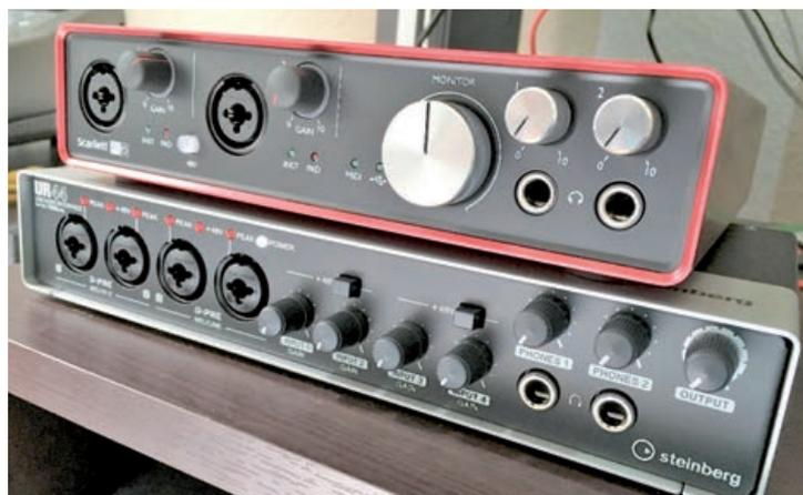
Während das „Scarlett 6i6“ einen digitalen S/PDIF-Anschluss aufweist, verfügt das UR-44 von Steinberg über einen integrierten DSP
