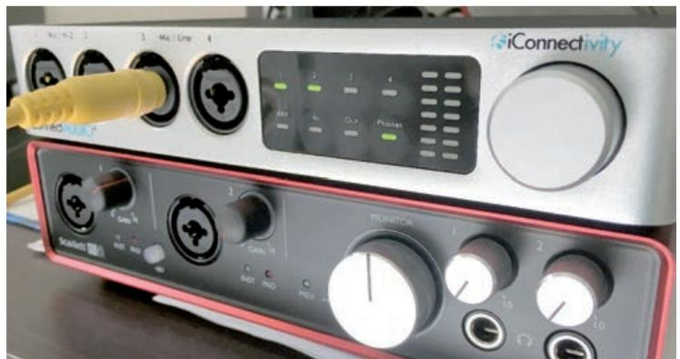
Das iConnectivity „iConnectAudio 4+“ Interface besitzt als einziger Testkandidat ein berührungsempfindliches Display und einen Encoder – darüber hinaus ermöglicht es das Routing von Audiosignalen zwischen zwei Computern oder iOS-Geräten
