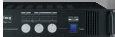
3-Kanal-Verstärker mit integrierter Frequenzweiche
