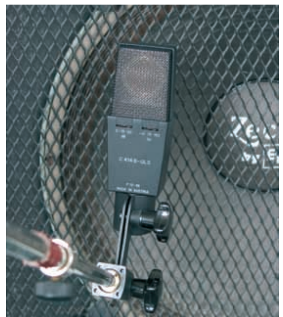
Das Mikrofon, hier ein AKG C-414B-ULS, wird zwischen Kalotte und Rand ausgerichtet
