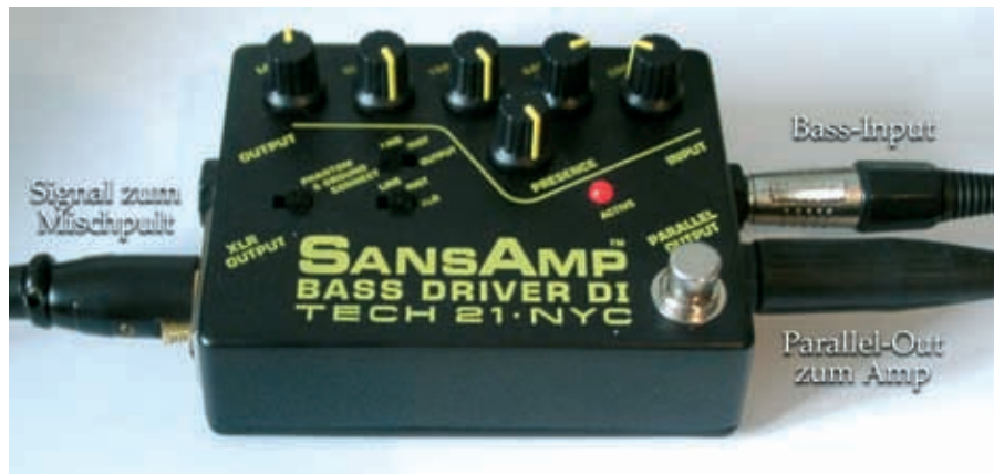
Über den Parallelausgang der DI-Box wird das Signal zweigeteilt – der Parallel-Output geht zum Amp, der XLR-Out zum Mixer
