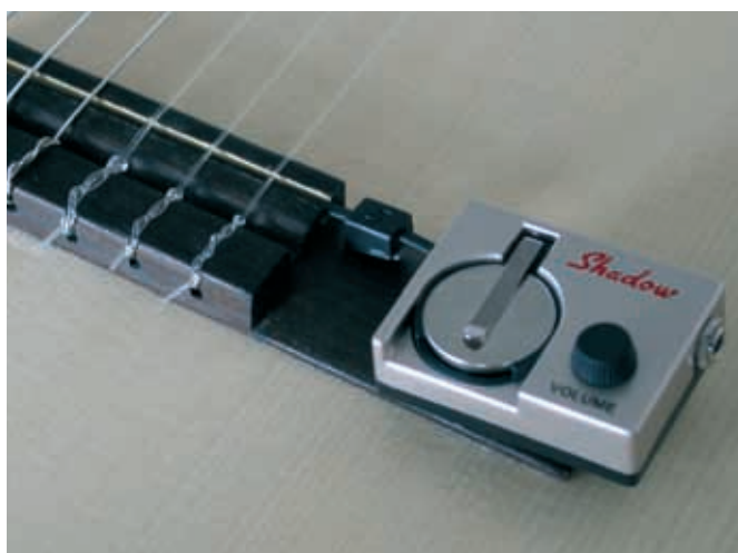
Beim Shadow SH AC NFX wird zunächst das Piezelement in den Stegschlitz gelegt ...
