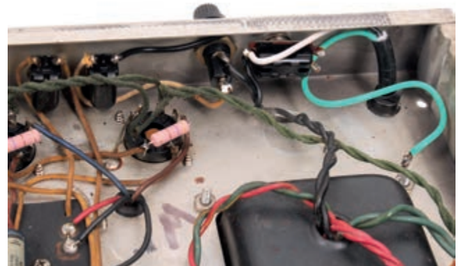
Netzkabel mit Schutzleiter und deaktivierter Ground Switch
