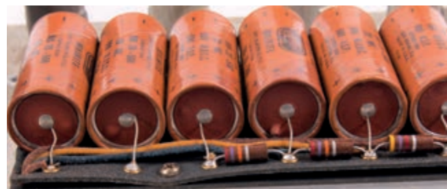
Netzteil Sieb-Elkos (Filter Caps) ursprünglich
