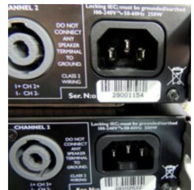
Abb 4: Die Leistungsaufnahme gibt der Hersteller mit 250 Watt (IPD-1200) und 500 Watt (IPD-2400) an
