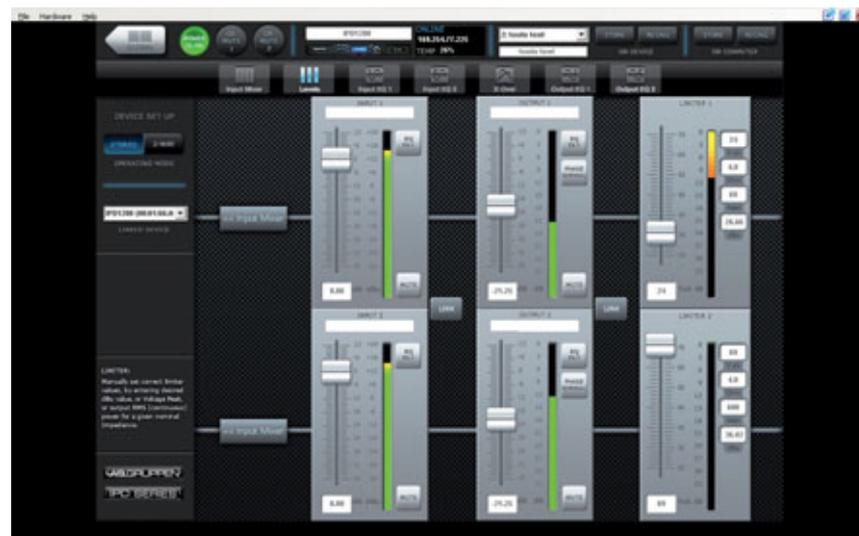
Abb 2: Die Software ist gratis erhältlich – im Bild wurde der Limiter von Kanal 1 auf knapp 27 dBu Limit-Wert eingestellt (Fader rechts oben)
