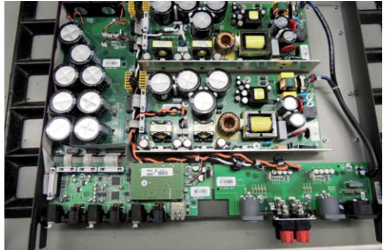
Abb 3: Die Lab.gruppen IPD-2400 ist mit zwei Netzteilen und erweiterter Kondensatorplatine doppelt so leistungsstark wie die IPD-1200
