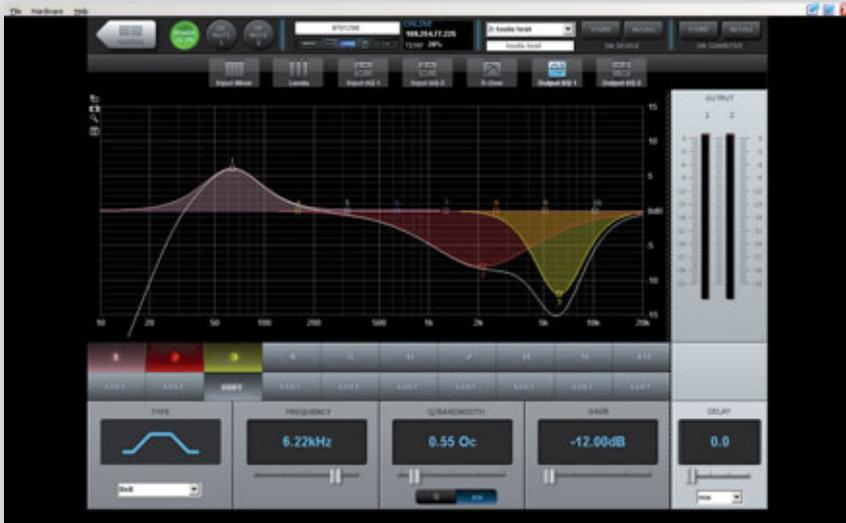
Abb 14: Der Editor zeigt den zu erwartenden Frequenzgang an und bietet mit bis zu zehn parametrischen Filtern pro Ein- und Ausgangsequelizer diverse Einstellmöglichkeiten
